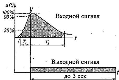
Рис. 10.106. Входной импульс, прикладываемый к реле при испытаниях, и сигнал на выходе ( T_1/T_2 = 8/20 мксек)
