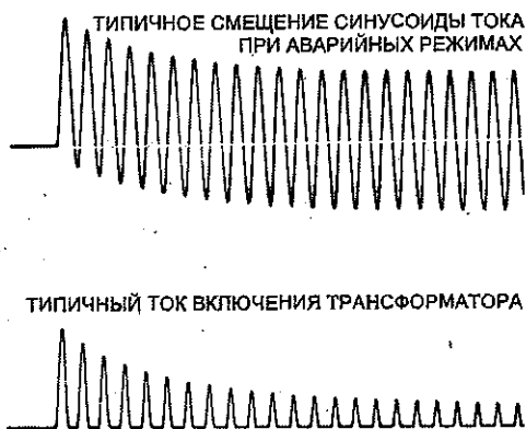
Рис. 10.97. Типичные осциллограммы токов короткого замыкания в линии и бросков тока намагничивания при включении трансформатора
