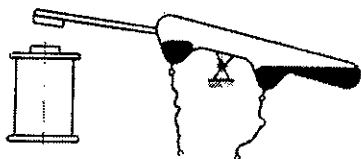
Рис. 3.55. Принцип построения реле с ртутным контактом
