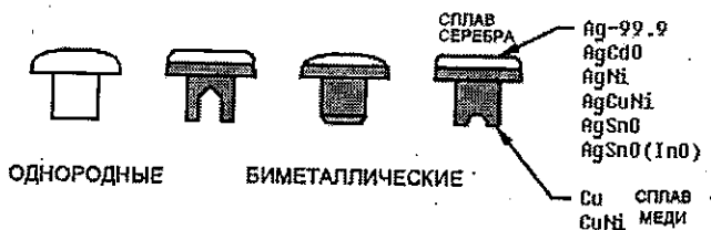
Рис. 3.2а. Контактные накладки типа заклепок
