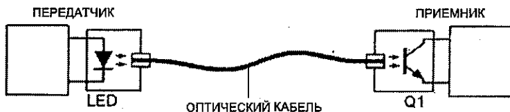
Рис. 7.107. Оптоэлектронное реле со световодом
