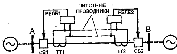
Рис. 12.27. Схема продольной дифференциальной защиты с использованием двух реле, установленных на двух концах линии
