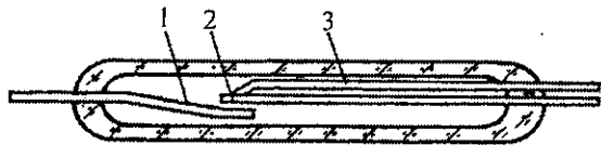
Рис. 5.9. Переключающий геркон: 1 — неподвижная контакт-деталь замыкающегося контакта; 2 — гибкая подвижная контакт-деталь; 3 — неподвижная контакт-деталь размыкающегося контакта
