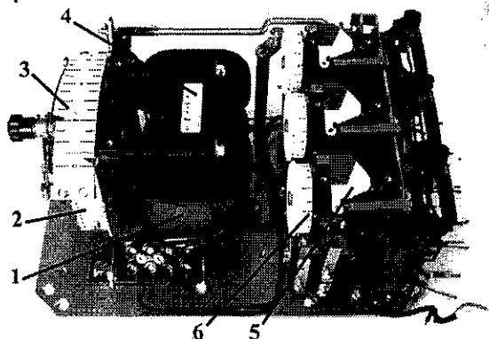
Рис. 10.66с. Конструкция реле RSZ 3gk: 1 — катушки электромагнита часового механизма; 2 — часовой механизм; 3 — шкала часового механизма; 4 — магнитопровод электромагнитка; 5 — поворотный флажок, открывающий красный сектор при срабатывании реле, 6 — шкала настроек реле тока I >
